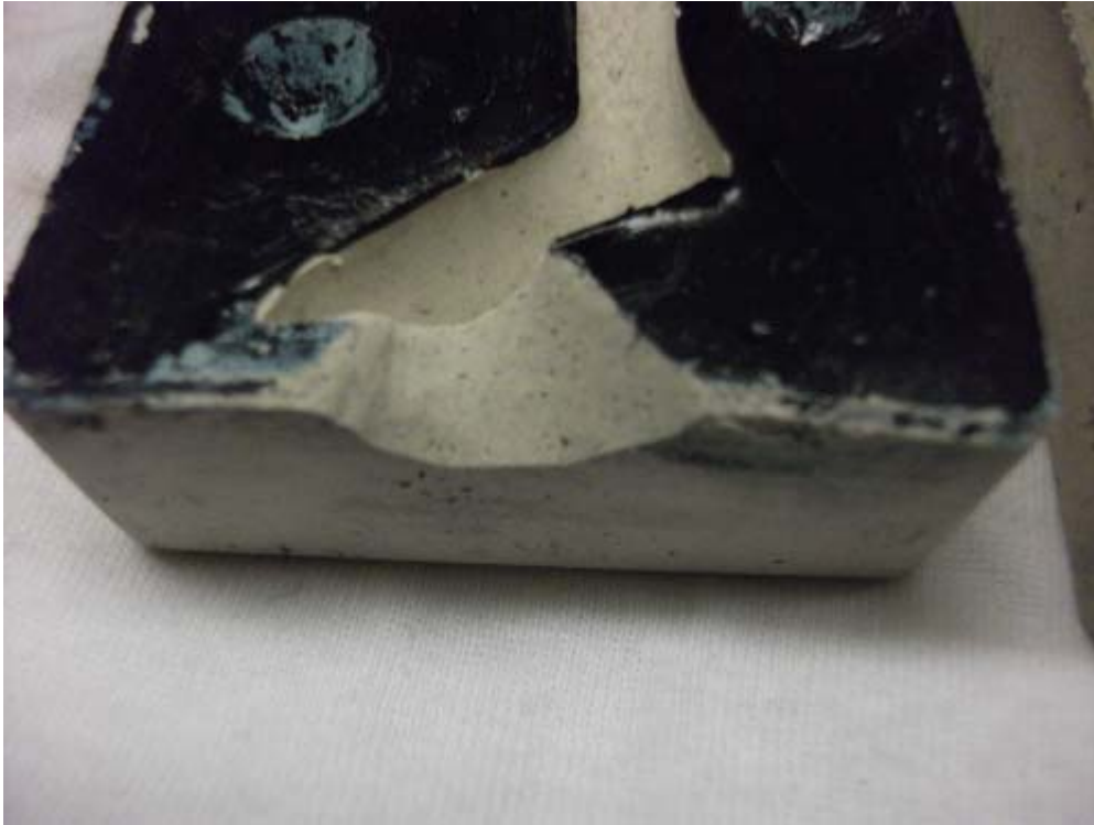
Einfüllkanal an der Unterform
