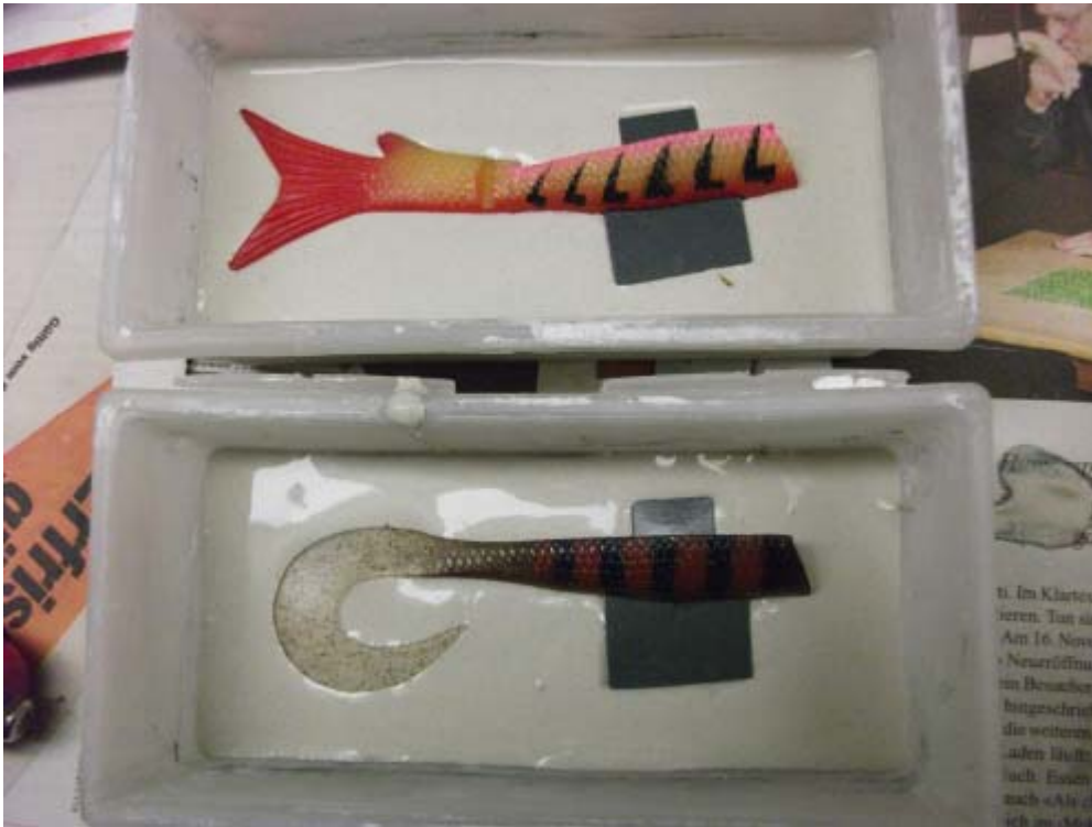
Untere Hälfte der Formen direkt nach Einlegen des Prototyps
