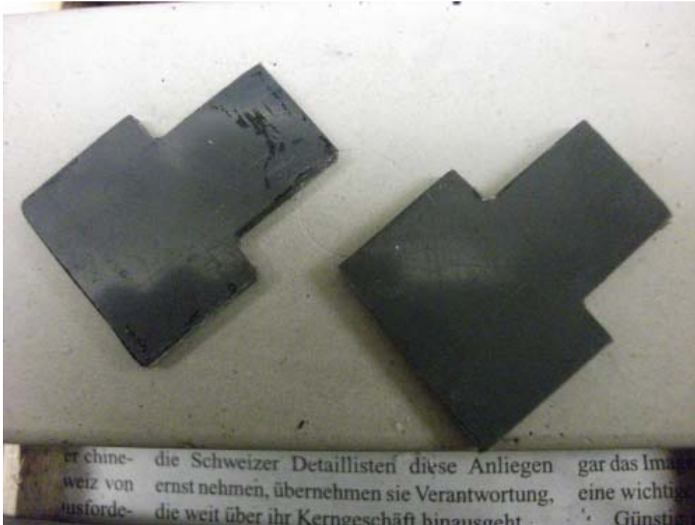
Einlage für den Schlitz im Gummikörper
