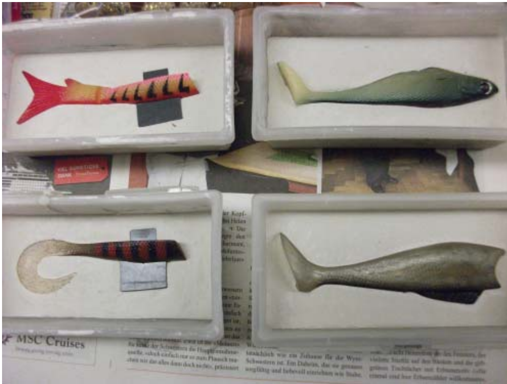
Formen nach Aushärtung der unteren Formenhälften
