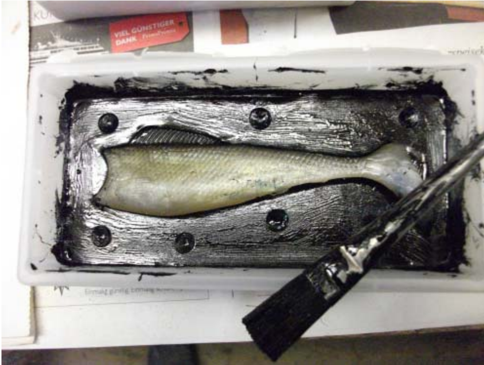
Form nach dem Einstreichen mit schnell trocknender Anreissfarbe
