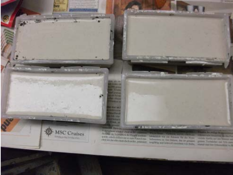
Gießbehälter aufgefüllt bis ca. 10mm unter den oberen Rand
