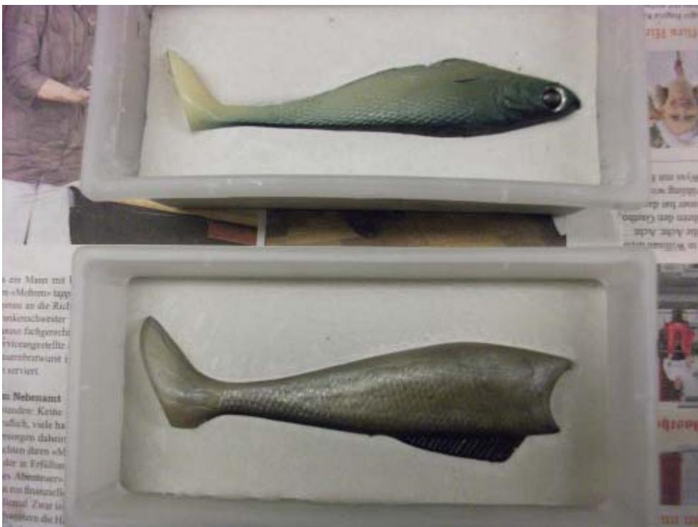
Untere Hälfte der Formen nach Einlegen des Prototyps, Gips schon leicht erhärtet
