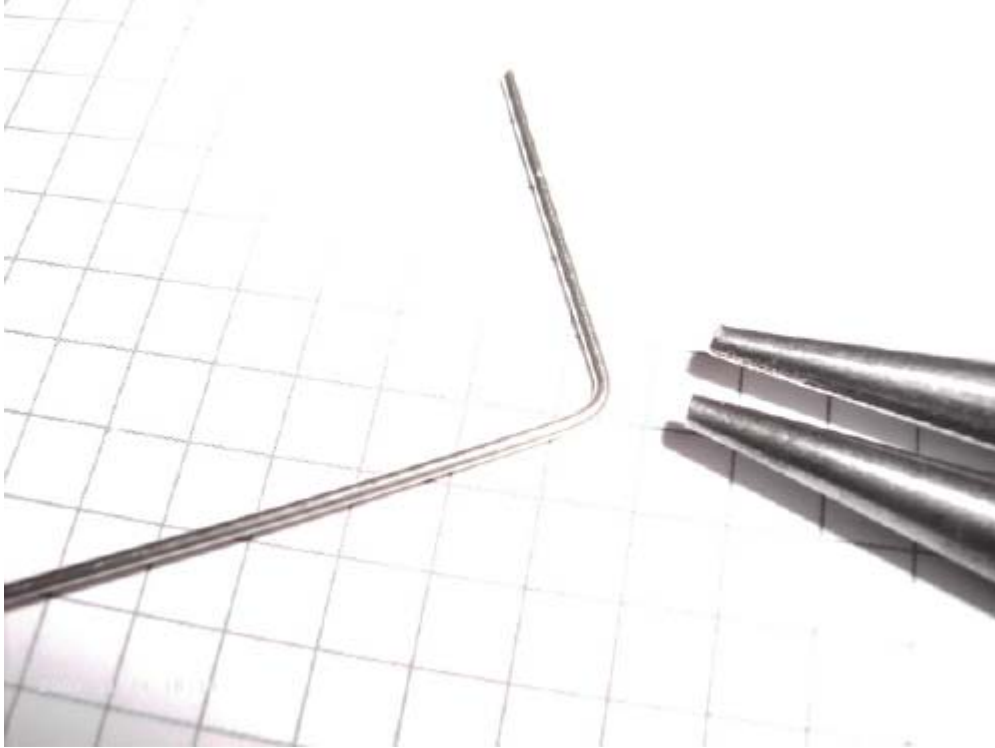
Draht im 90 Grad Winkel gebogen
