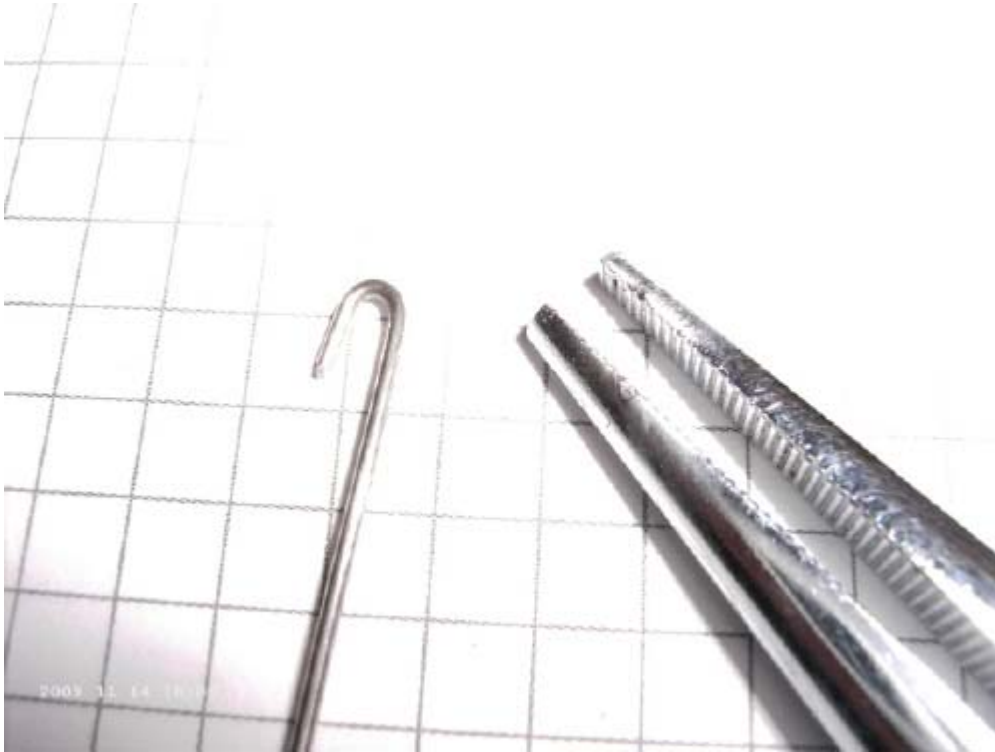
Draht 180 Grad gebogen und eben
