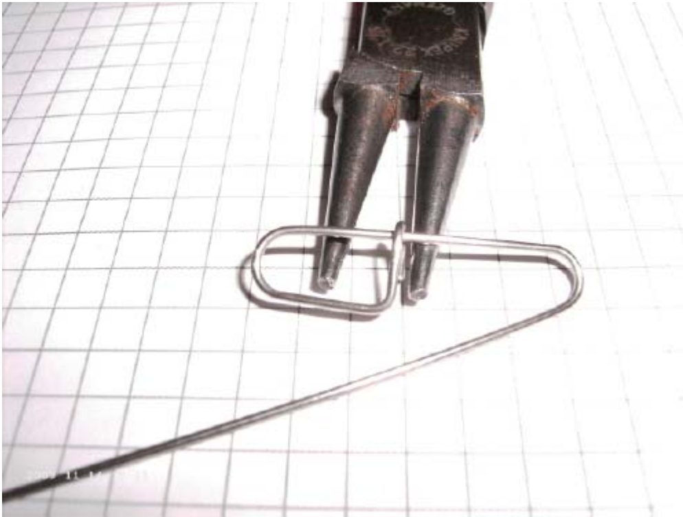
Rückbiegung für Öse 2 mit ca. 150 Grad
