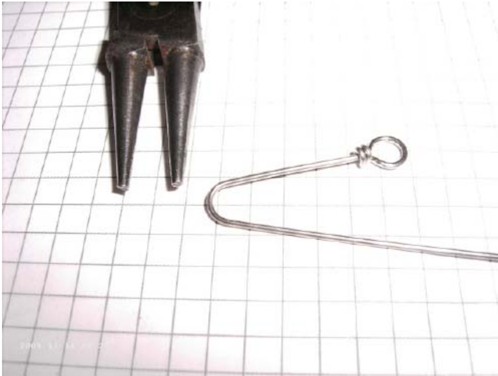
150 Grad Biegung, die Rundöse liegt flach auf
