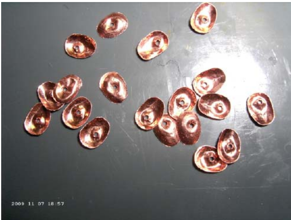
Rohlinge aus Kupferfolie 0,1mm, mit Stanzform 1 ausgestanzt
