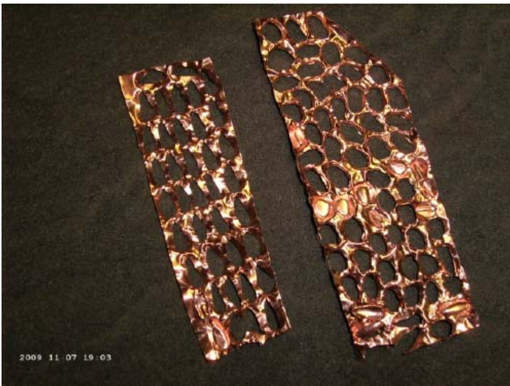
Restfolie, nach dem Ausstanzen; die „Fehlstanzen“ stammen noch von den Versuchen bei der Herstellung der Stanzen.
