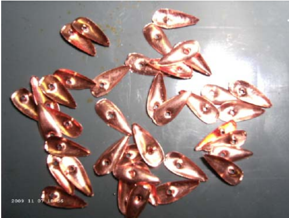
Rohlinge aus Kupferfolie 0,1mm, mit Stanzform 2 ausgestanzt
