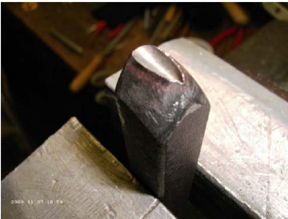
Stanzform 2 aus Stahl 15x15mm
