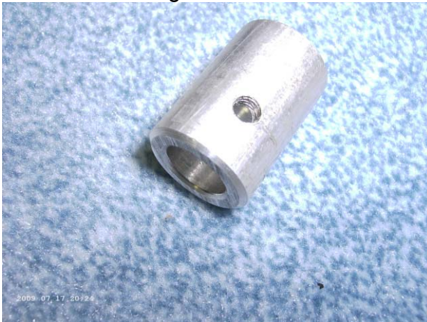
Das Verbindungsteil von 15er zum 12er-Rohr
