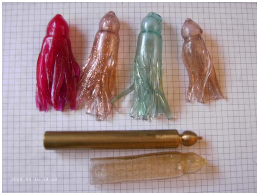
„Tintenfisch“ mit abgedrehtem Messing \varnothing 15mm hergestellt
