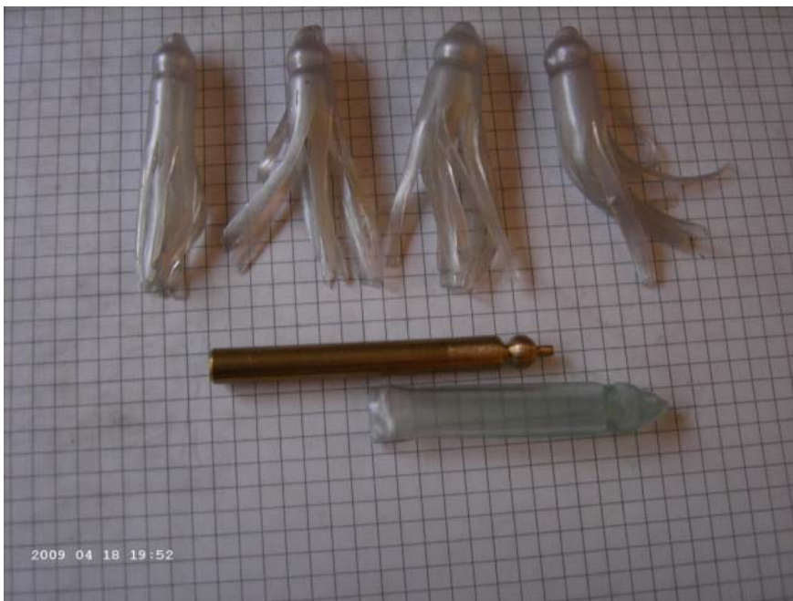
„Tintenfisch“ mit abgedrehtem Messing \varnothing 10mm hergestellt
