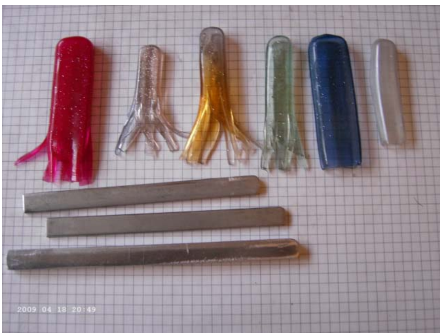
„Rechteckröhre“ mit Alu-Rechteckprofilen 10/2,5mm und 10/5mm hergestellt, Vorderkante gerundet
