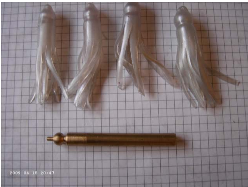
„Tintenfisch“ mit abgedrehtem Messing \varnothing 8mm hergestellt
