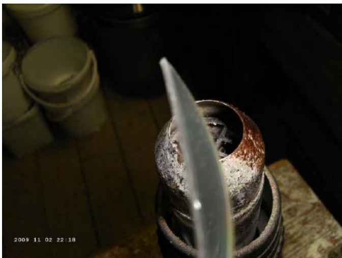
Aufwärmphase beim Verformen des Spinnerblattes
