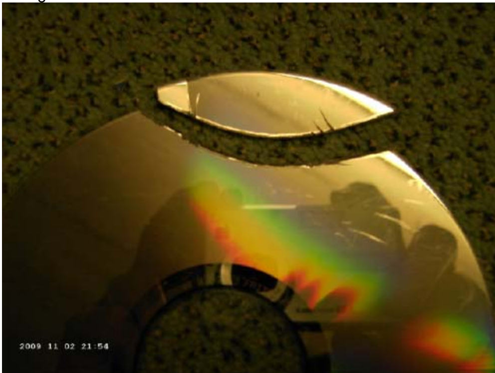
Risse und Absplitterungen, Ursache: CD nicht vorgewärmt
